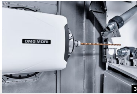
1: Werkzeugkettenmagazin für bis zu 180 Werkzeuge 2: Werkzeugeingabestation mit optimaler Zugänglichkeit von vorne 3: Zusatzmagazin für 6 über- große Werkzeuge bis 700 mm Länge oder \varnothing 200 mm (optional für alle CTX gamma TC Maschinen) 4: Scheibenmagazin mit 36 Stationen
