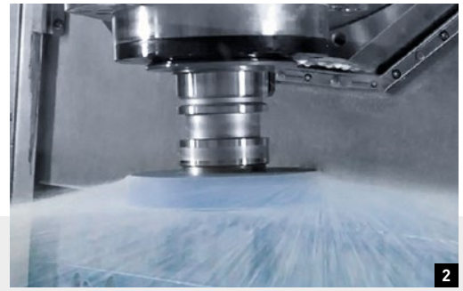
1: Körperschallsensorik: Überwachung des Abrichtvorganges 2: Werkzeugtechnologie: Standardisierte Schleifscheibenhalter mit IKZ 3: Inprozessmessen: Mess-Wiederholgenauigkeit bis 0,8–1,0 µm (Marposh Micromar 8)
