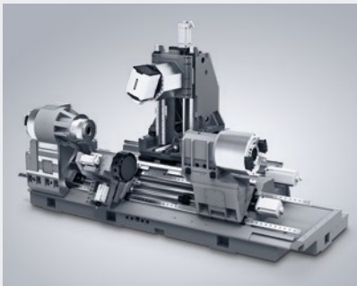
Bauweise: FEM-optimierte Bauweise mit hohen statischen und geringen bewegten Massen
